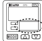
设定基准值时，只有次显示屏显示转换，所以下图的显示仅为次显示屏的显示。
